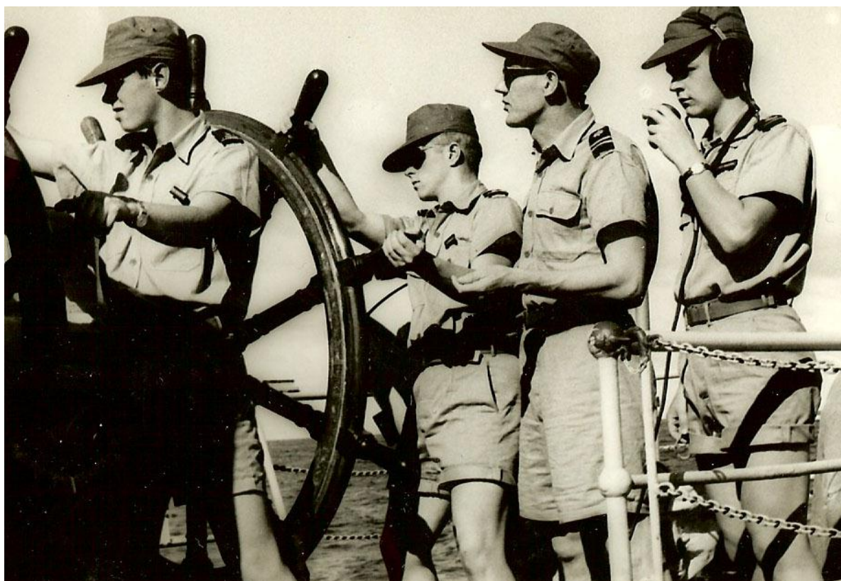
Manuell nödstyrning testas från den i aktern placerade dubbelratten – styrning på segelfartygens vis!
